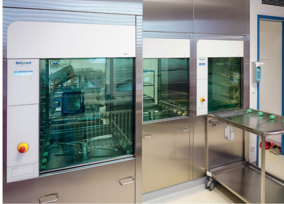
Neue moderne Durchreichewaschmaschinen (RDG) zur Reinigung und Desinfektion der gebrauchten OP-Instrumente
